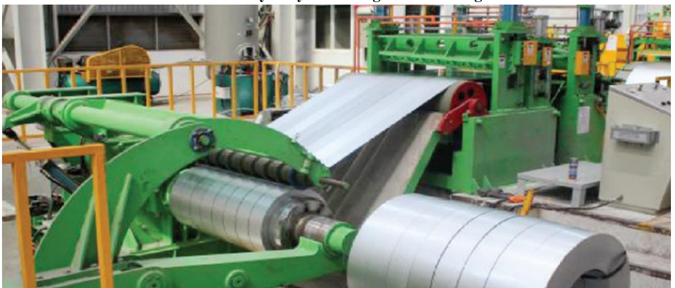
Hình 13: Dây chuyền xả băng của Tôn Đông Á
