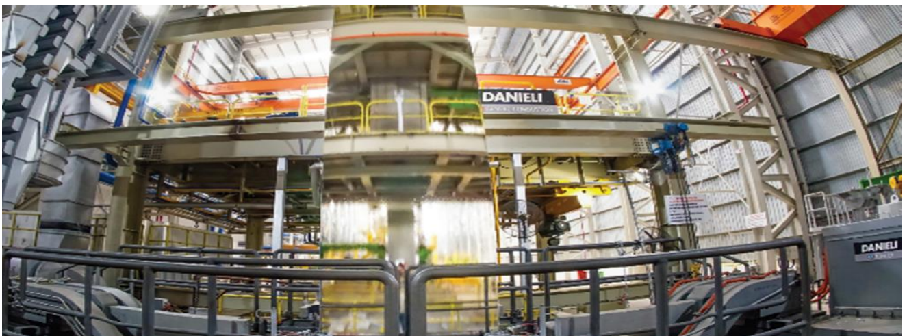
Hình 7: Hệ thống chảo mạ của Tôn Đông Á
